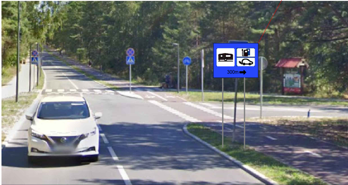
Esamas ženklas nr. 711, keičiamas nauju kombinuotu ženklu nr. 711 ir 735, dydis 0 gr., sumontuojant naujas atramas Ženklo aukštis nuo žemės lygio - 2,2m. X: 6133695,1; Y: 308933,79
