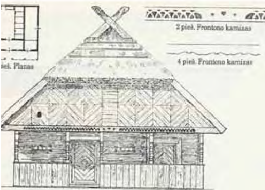
„Juodkrantės klėtis pastatyta iš ištisinių tašų (šoninės sienos tašas – iš vieno medžio). Kampuose sujungta senuoju būdu į sąsparą (kregždės uodegos forma). Frontono viršus užkaltas vertikaliai lentomis, tradiciškai paliekant dureles pelėdai (aitvarui). Klėtės durys buvo uždaromos iš vidaus, kaip ir Juodkrantės klėtis.“ „Kuršių nerijos tradicinė architektūra“, 2011, Leidykla „Libra Memelensis“
